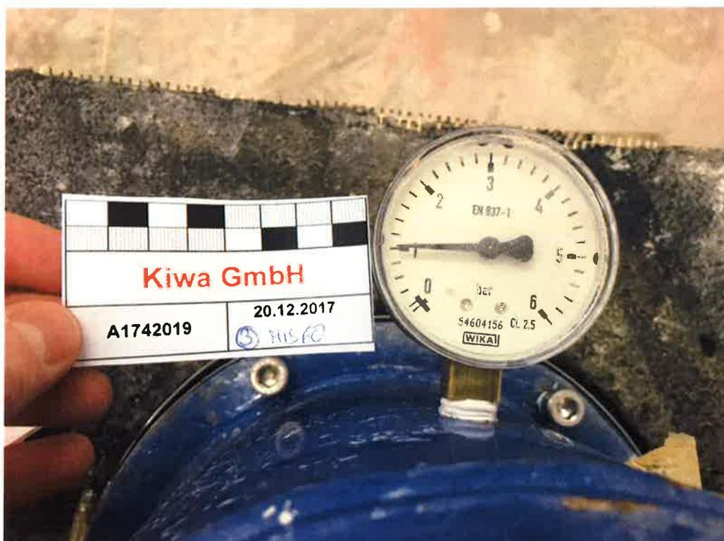
Abbildung A2. Druckdichtigkeitsprüfung mit der wassergefüllten Druckglocke bei einem Nenndruck von  $\geq 1,0$  bar (Manometerstand nach 28 Tagen am 20.12.2017).
