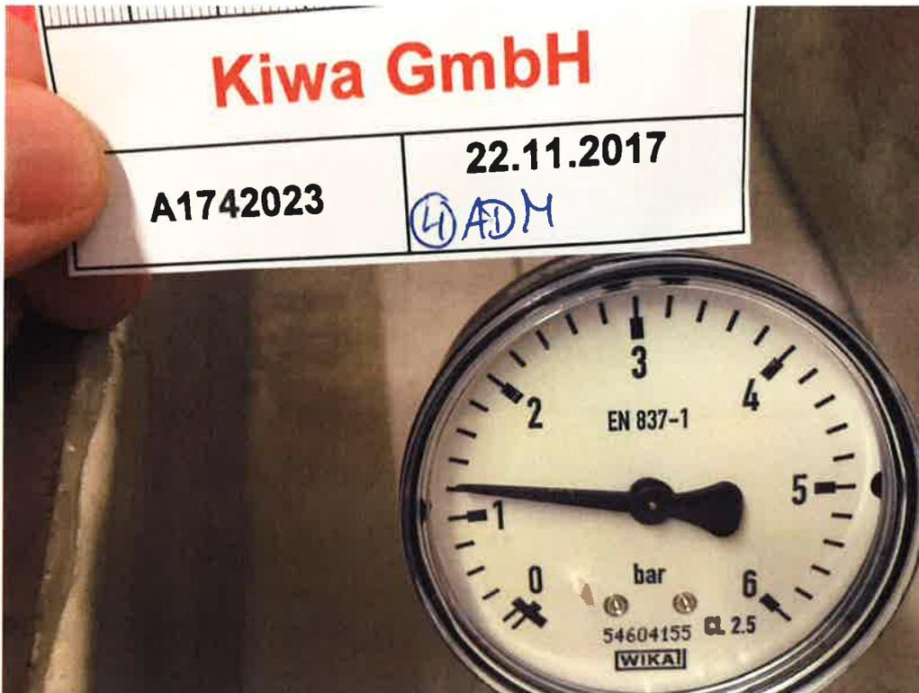
Abbildung A1. Druckdichtigkeitsprüfung mit der wassergefüllten Druckglocke bei einem Nenndruck von  $\geq 1,0$  bar (Manometerstand bei Versuchsbeginn am 22.11.2017).
